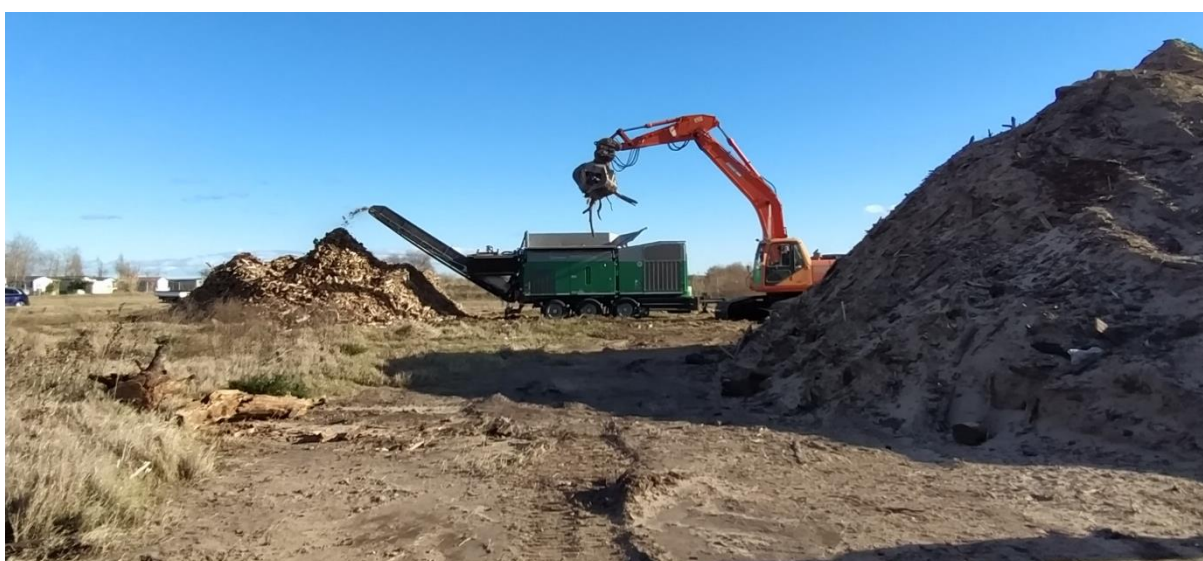
Figure 56 : Broyeur lent à végétaux Komptech utilisé par la SAS Cap sud TP pour un chantier de broyage en Occitanie (EID Méditerranée, 2021)
