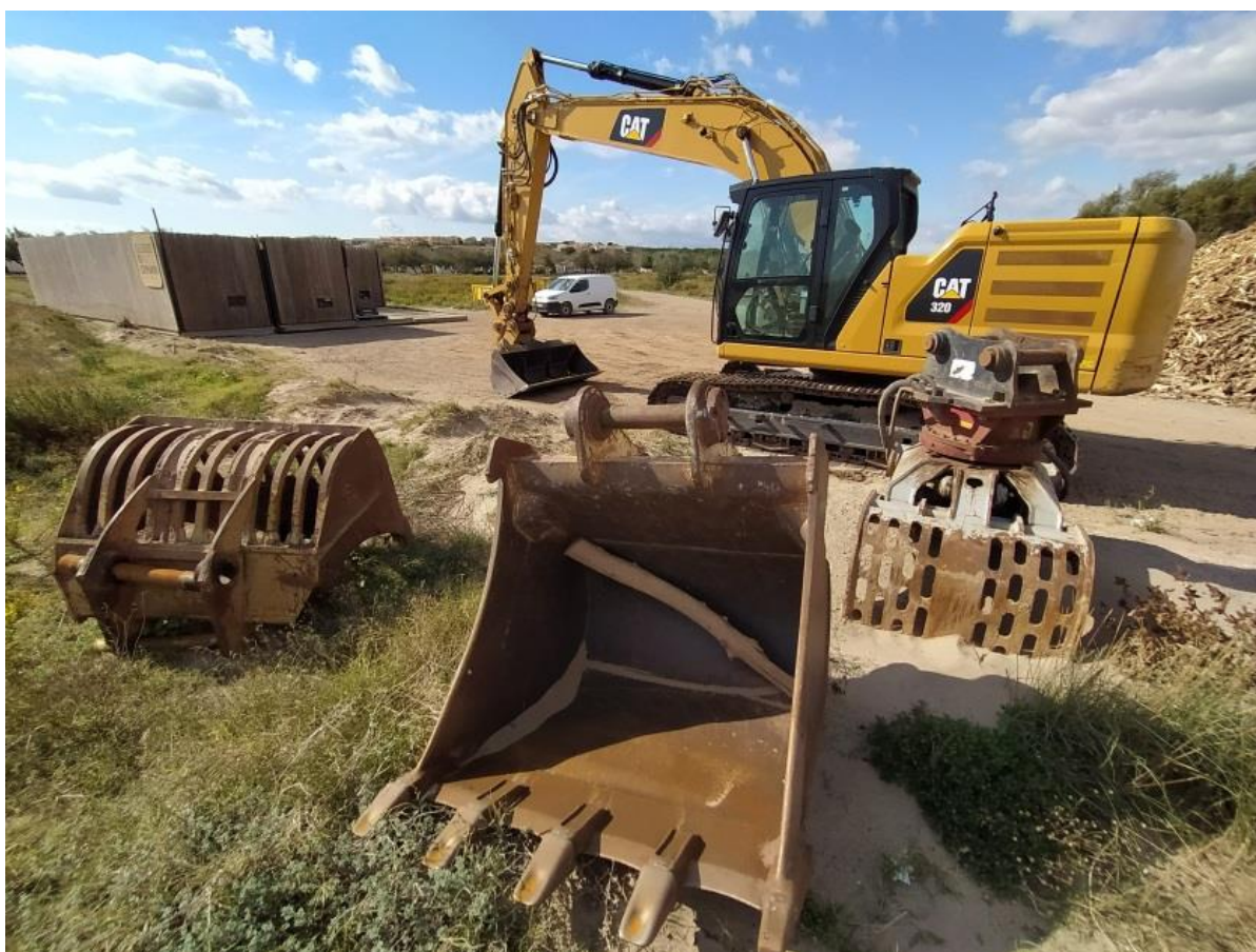
Figure 38 : Tractopelle à chenilles et godets (de gauche à droite : godet claire voie, godet classique, pince de tri et godet de curage sur la pelle) utilisés par Cap Sud TP et photographiés sur le chantier de bois flottés de la tranche ferme à Fleury-d'Aude (EID Méditerranée, 2020)
