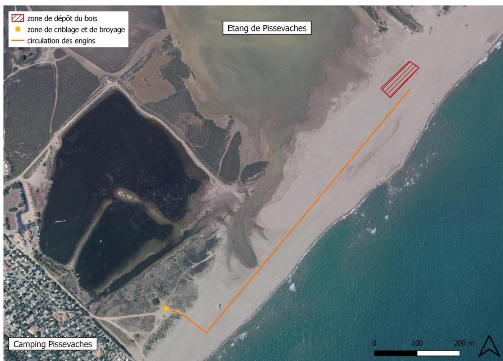
Figure 2 : Plan du chantier de broyage de la tranche ferme à l'étang de Pissevaches (EID Méditerranée, 2020)
