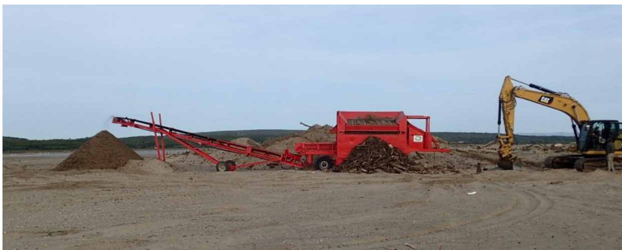
Figure 39 : Cribleur utilisé par Cap Sud TP sur la plage de Fleury-d’Aude, au niveau de l’étang de Pissevaches (EID Méditerranée, 2020)
