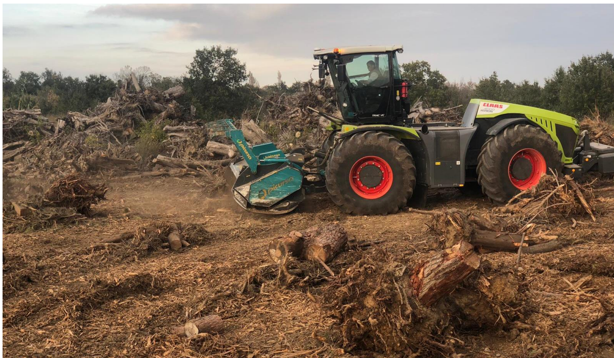
Figure 55 : Broyeur forestier Picursa utilisé par la société Travaux des Aspres pour un chantier de broyage en Occitanie (SARL Travaux des Aspres, 2020)
